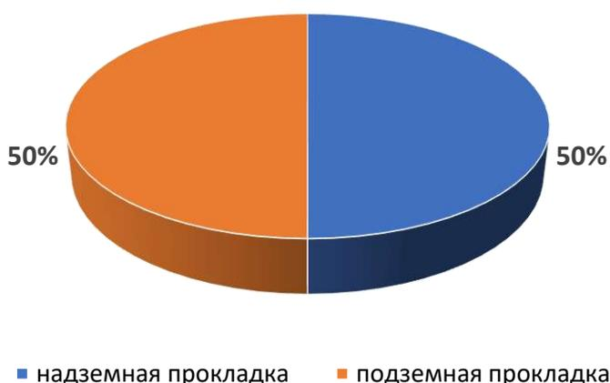
Рисунок 1.4. Распределение сетей ГВС котельной №7 по типу прокладки
