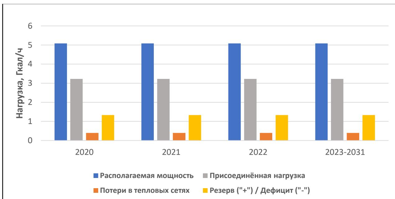
Рисунок 4.1. Балансы тепловой мощности и перспективной тепловой нагрузки котельной №7 д. Б. Сабск
