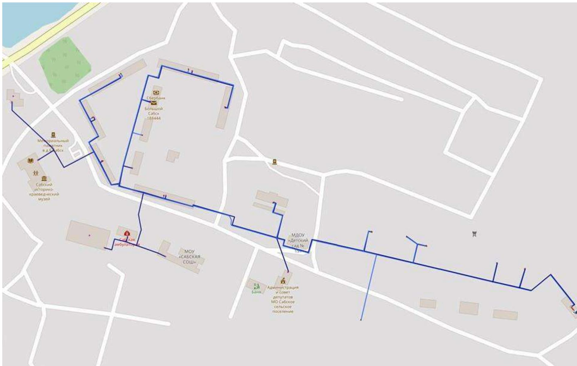
Рисунок 4.2. Схема тепловых сетей котельной №7 д. Б. Сабск на 2031 год
