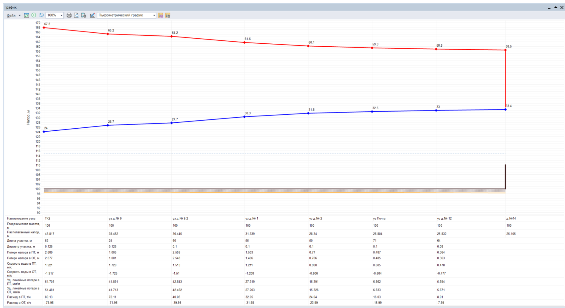
Рисунок 1.3.4 – Пьезометрический график с учетом резервного трубопровода
