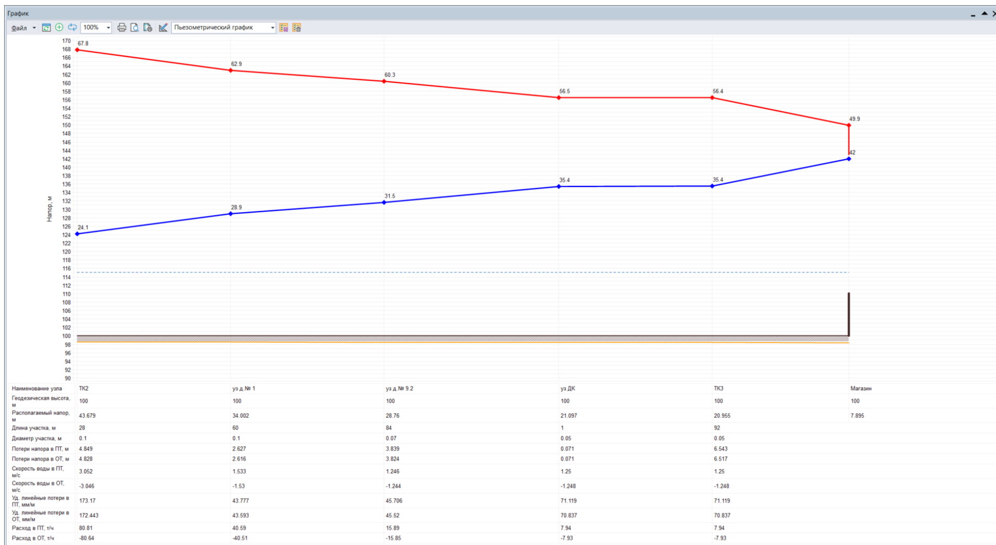
Рисунок 1.3.8 – Пьезометрический график с учетом резервного трубопровода
