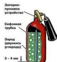
**ПРИНЦИП ДЕЙСТВИЯ** основан на вытеснении двуокиси углерода избыточным давлением. При открытии запорно-пускового устройства CO<sub>2</sub>, по сифонной трубке поступают в распылитель и из сжиженного состояния переходит в твердое (снегобразное). Температура резко ( $-70^{\circ}\text{C}$ ) понижается. Углекислота, попадая на горячее вещество, изолирует его от кислорода
