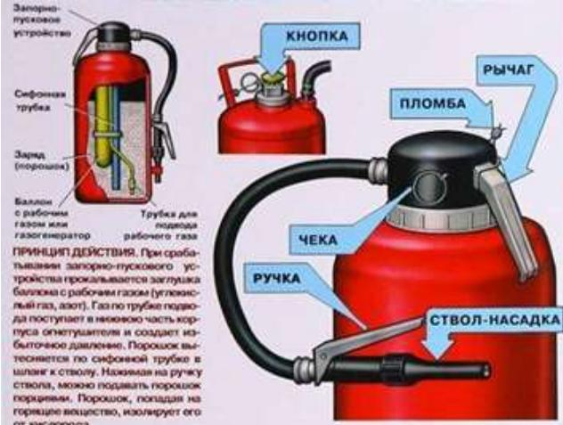
**ПРИНЦИП ДЕЙСТВИЯ.** При срабатывании запорно-пускового устройства прокальвается заплашка баллона с рабочим газом (углекислый газ, азот). Газ по трубке подается в нижнюю часть корпуса огнетушителя и создает избыточное давление. Порошок вытесняется по сифонной трубке в шланг к стволу. Нажимая на ручку ствола, можно подавать порошок порциями. Порошок, попадая на горячее вещество, изолирует его от кислорода
