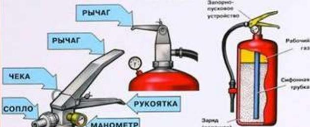
**ПРИНЦИП ДЕЙСТВИЯ.** Рабочий газ закачан непосредственно в корпус огнетушителя. При срабатывании запорно-пускового устройства порошок вытесняется газом по сифонной трубке в ствол-насадку и в сопло. Порошок можно подавать порциями. Он попадает на горячее вещество и изолирует его от кислорода
